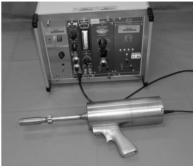
Abbildung 1: Im Klinikum Augsburg entwickelte Gammasonde zur intraoperativen Lokalisierung von radioaktiv markiertem Tumorgewebe. Das futuristisch erscheinende Messgerät wurde bereits im Jahr 1987 gebaut und war weltweit eine der ersten einsetzbaren Gammasonden.
