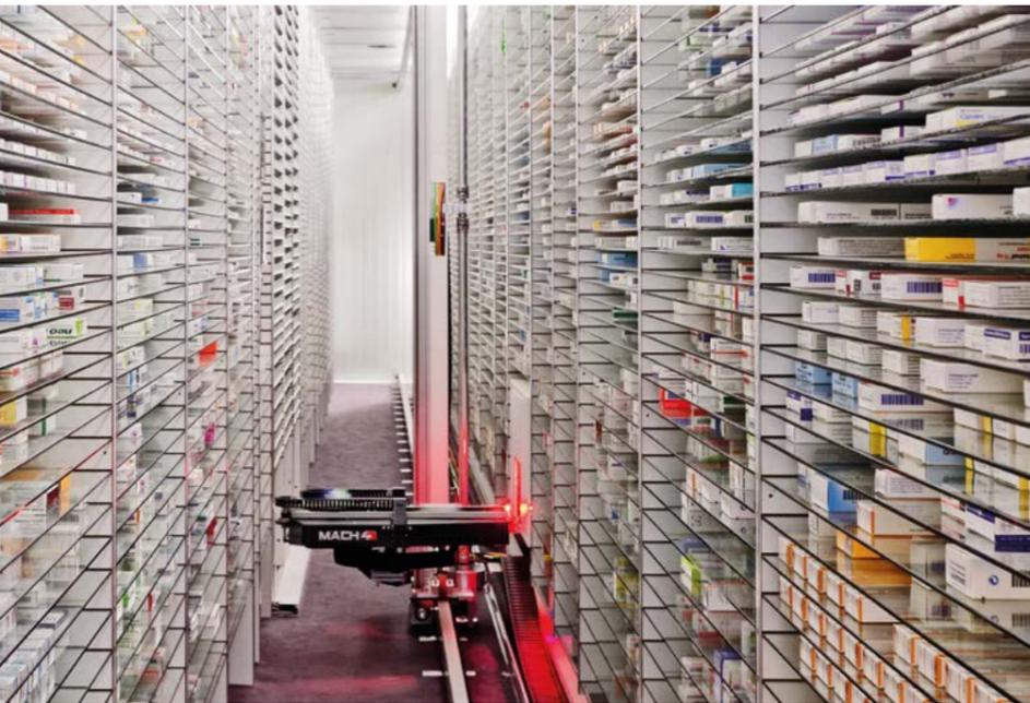
**Bis zu 85 000 Arzneimittel lagern im Kommissionierautomat der Apotheke. Roboter kennen den Lagerort der bestellten Medikamente und sortieren die Packungen innerhalb von wenigen Sekunden zum entsprechenden Auftrag.**
