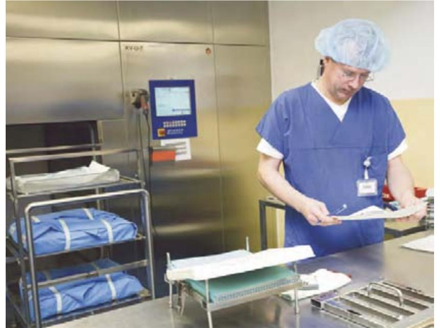
Nach einer letzten Kontrolle der verpackten Pakete werden sie in den Dampfsterilisator geschoben, dessen Tür bereits offensteht.
