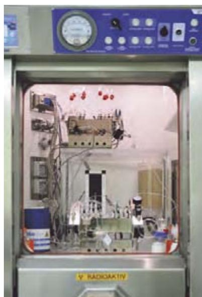
Eine dicke, strahlendichte Bleiglas-scheibe erlaubt den Ärzten und MTAs Sichtkontakt beim Hantieren der radioaktiven Stoffe mit „Roboterarmen“.
